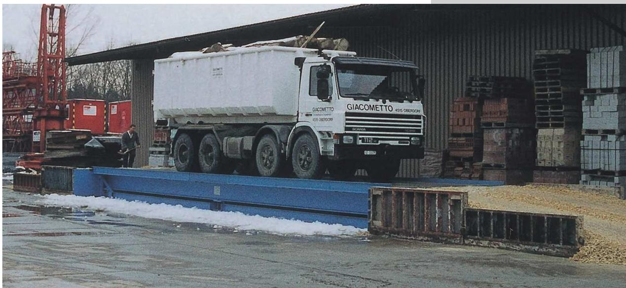
Le pont-bascule PMA type **TRANS3** est l'outil idéal pour les entreprises du bâtiment, des travaux publics, des carrières et sablières. Facilement transporté et rapidement mis en service, le pont-bascule **transportable** de chantier **TRANS3** est la solution pour une installation de **pesage des véhicules** définitive ou temporaire. En effet, si les besoins ne sont que de quelques mois, TRANS 3 peut être **loué**.
