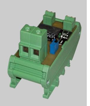
Le transmetteur CAL35CC permet la mesure de courant continu jusqu'à 100 ampères, se substituant avantageusement aux shunts de mesures, en réduisant les pertes d'insertions et en fournissant un signal mis en forme (4..20mA, 0...10V ou mV). la version ouvrante convient plus particulièrement pour le rétrofit d'installation existante et permet même une mise en place sans arrêt de l'installation.
