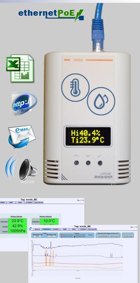
La SAI60 est une sonde d'ambiance destinée aux applications de régulation et traçabilité de salles à atmosphère contrôlée. Connectée au réseau Ethernet, cette sonde permet le rapatriement des mesures par protocole Modbus/TCP ou SNMP et l'envoi de mail d'alarme.
