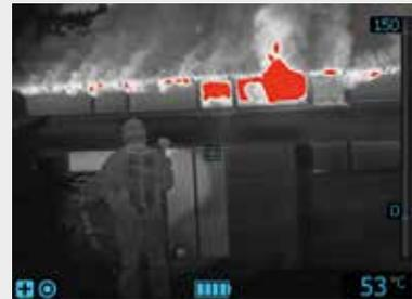
Haute sensibilité entre 100 et 150 ° c, une palette de gris avec la colorisation de 2 % des zones les plus chaudes de la vue. Utilisé pour la recherche de hotspots.
