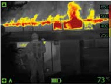
Utilisé lorsque les températures sont élevées. Par exemple lorsqu'une structure est en feu. Lorsque les flammes sont déjà nombreuses et que l'environnement est très chaud.
