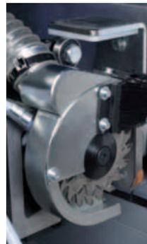
Les guidages linéaires de haute précision garantissent des coupes parfaites du dispositif de cisaille grâce à deux lames de scie de découpe.
