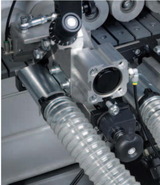
Affine l'usinage de l'effleurage et enlève les résidus de colle. Sélection pneumatique depuis le tableau de commande avec boîtier de récupération de copeaux pour les coupes à araseurs.
