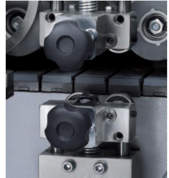
Le racleur de surface à démarrage manuel garantit une parfaite finition de la surface de pièces.
