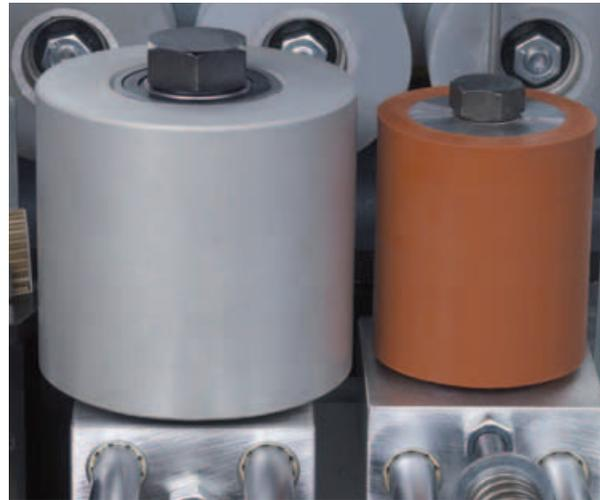
Le premier cylindre presse le type de chant sur la pièce. Le rouleau de pression postérieur est pressée mécaniquement par un ressort et ferme le joint de colle en haut et en bas. Le réglage sur l'épaisseur de chant se produit par l'insertion d'une section de chants.
