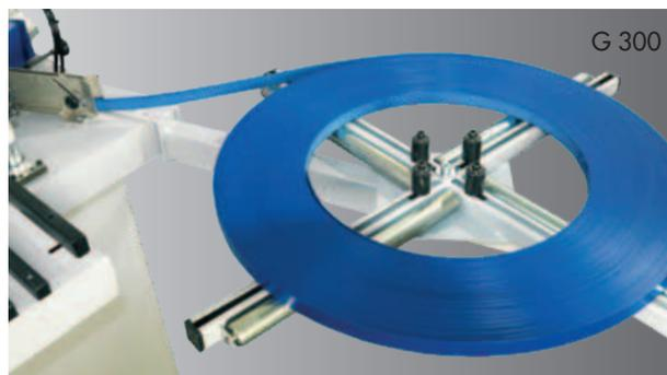
Plateau pour bande de chants de 0,4 à 2 mm (G 300 3 mm) avec rouleaux et sécurité contre débordement. Sur la G 300, le plateau est inclinable afin de pouvoir changer l'angle de guidage du chant pour un matériel de chants de 3 mm.
