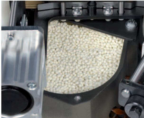
Le bac à colle à revêtement en téflon a une contenance de 1,2 kg de granulé de colle à fusion EVA (Ethylène-Acétate de vinyle-Copolymerisat). Après une courte période de réchauffement, la machine est prête à l'emploi. Le cylindre encolleur à réglage fin assure le bon dosage de la colle à fusion et permet une adhésion parfaite sur tous les différents types de chant. Les granulés de colle à fusion PUR (Polyuréthane) doivent être traités selon les directives de traitement de la colle.
