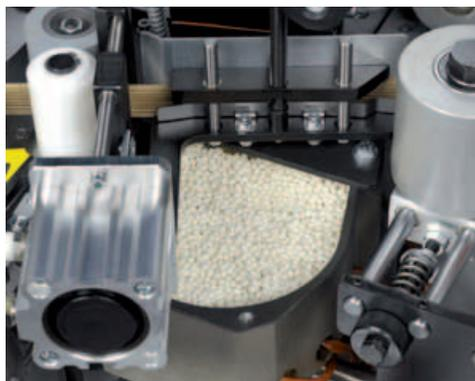
Bac à colle en teflon avec une capacité de 1,2 kg. Bac pour colle granulée thermo fusible. Rouleau encolleur réglable.
