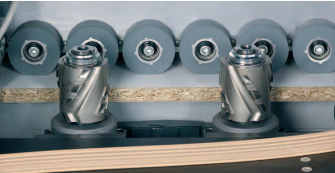
Un agrégat de dressage avec deux porte-outils hélicoïdaux diamantés, travaillant en sens contraire, garantissent un usinage parfait du chant des pièces. Grâce à l'agrégat de dressage vous obtenez un chant sans aucun éclat.
