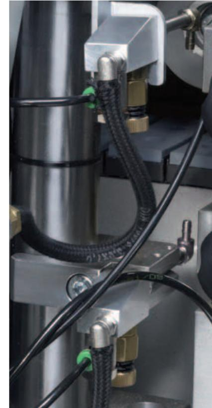
Une consommation réduite grâce au pilotage des buses de vaporisation pour l'application d'un agent de démoulage pour la colle PUR, ou/et d'un produit de nettoyage et de polissage pour garantir des pièces propres et une parfaite finition.
