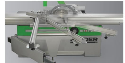
Pour les coupes inclinées de 90° à 45°, le guide télescopique 2600 mm se fixe à la position souhaitée sur la table coulissante, avec une butée d'arrêt à 90°. Guide d'index avec possibilité de blocage au pas de 5°.
