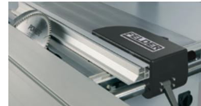
Pour les découpes de pièces étroites avec la lame de scie inclinée, il est possible de coucher le guide.
