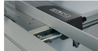
Le rail en alu du guide de scie circulaire peut être déplacé vers l'arrière pour des travaux arrêtés ou pour un meilleur guidage des pièces.
