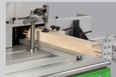
Tenonnage d'assemblage d'angles
