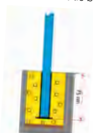
Fixation avec un fourreau en aluminium. Perte de hauteur hors sol.
