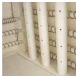
Tubes céramique perforés pour l'injection d'air frais préchauffé
