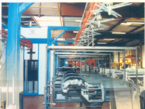
◀ REYDEL - Convoyeur aérien double voie avec balancelles support de pièces
