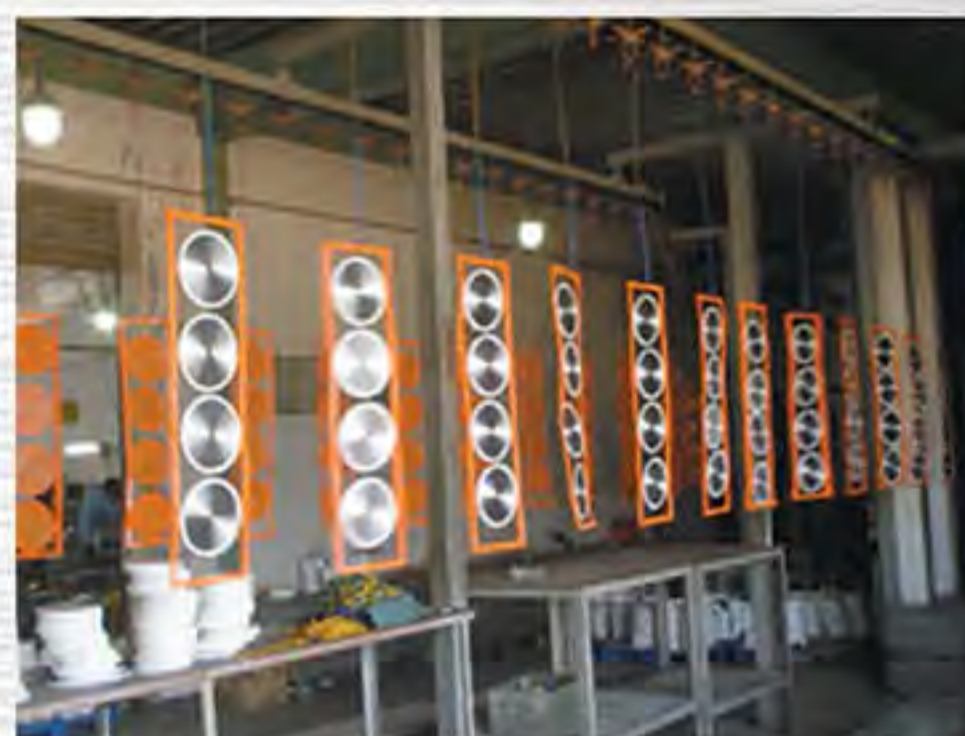
Cabine de peinture automatique
