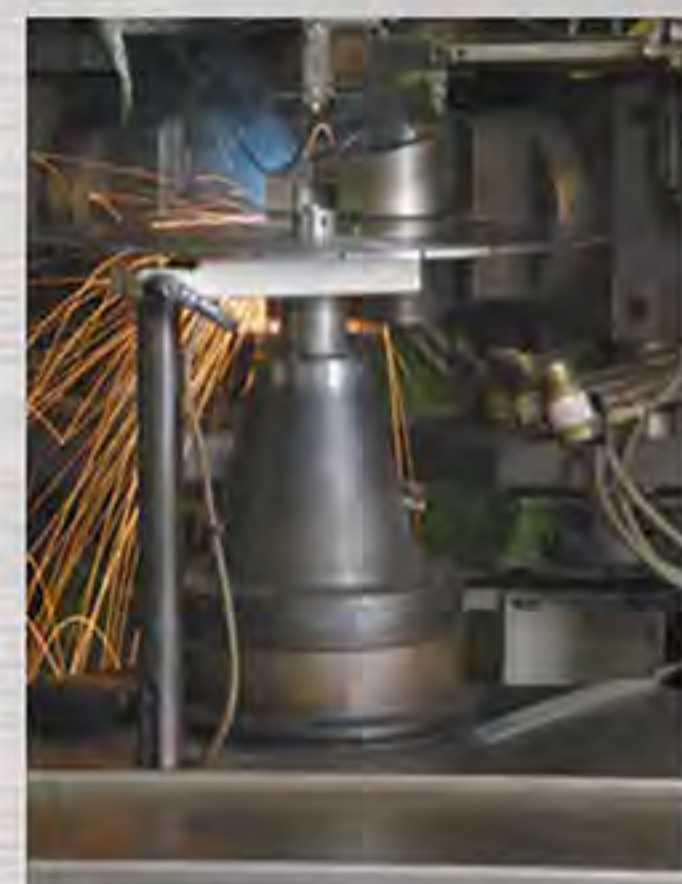
Soudure laser pour les diamètres courants
