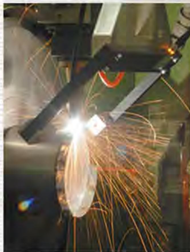
Soudure laser pour les couronnes
