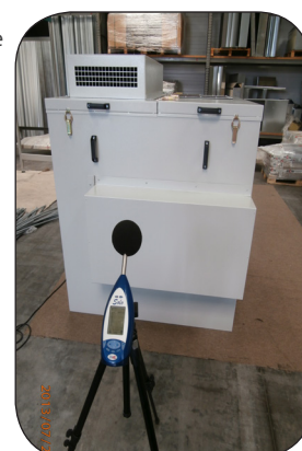
Méthode par insertion réalisée in situ sur capot autoportant
