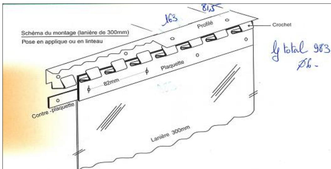
Profilé en inox = 1 m - nombre de crochets = 24 - Ø trous d'ancrage = 6,2 mm
