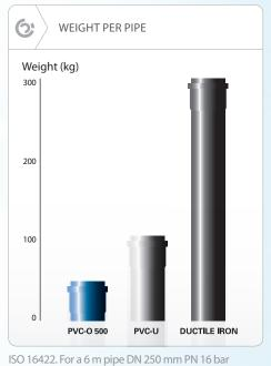
ISO 16422. For a DN 250 mm PN 16 bar pipe
