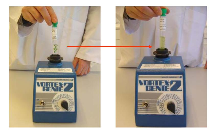
CAP THE TUBE AND SHAKE VIGOROUSLY TO DISSOLVE THE ALGINATE MATRIX OF THE ALGAL BEADS, PREFERABLY WITH THE AID OF A VORTEX SHAKER
