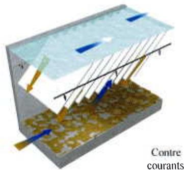
Lorsque les décanteurs se remplissent d'eau, un flotteur de commande ou un actionneur fait pivoter la structure lamellaire jusqu'à la position voulue.
