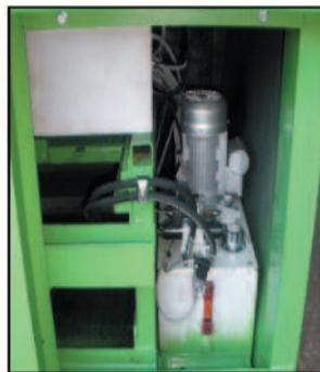
• Armoire électrique et centrale hydraulique
