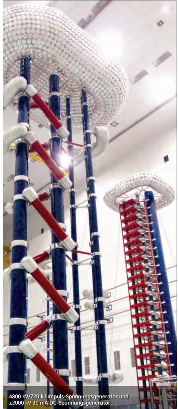
4800 kV/720 kJ Impuls-Spannungsgenerator und  $\pm 2000$  kV 30 mA DC-Spannungsgenerator
