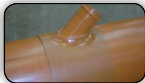
Fig. 25 - Prova ad urto UNI EN 744.
