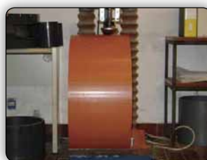
Fig. 25 - Prova ad urto UNI EN 744.
