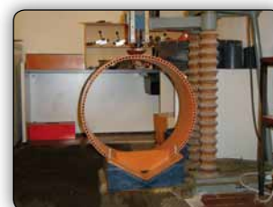
Fig. 26 - Prova ad urto UNI EN 744.
