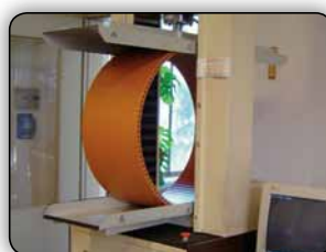
Fig. 23 - Prova rigidità anulare UNI EN 9969.
