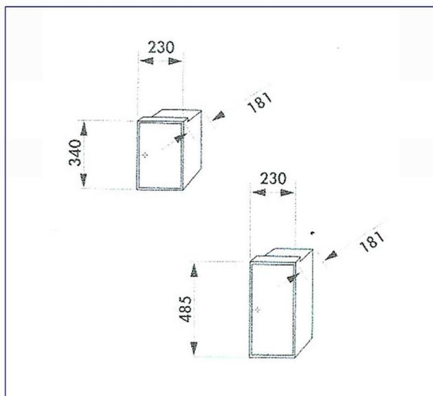
**Matériau : ciment renforcé en fibre de verre (CCV) - Façade beige - Poids : 43 Kg****A NOTER : Veuillez nous indiquer sur votre commande si les coquilles reçoivent les coffrets de la gamme CIBE**
