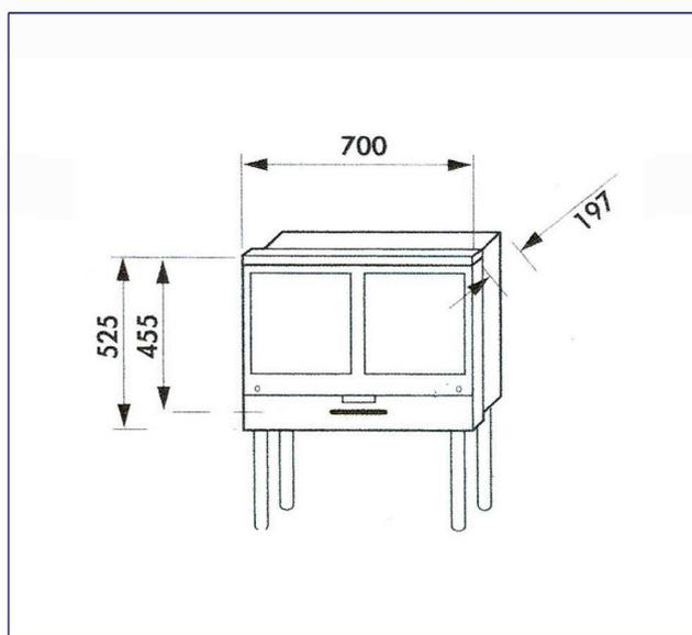
Matériau : ciment renforcé en fibre de verre (CCV) - Façade beige - Poids : 71 Kg
