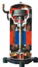
Le compresseur scroll à haute performance est équipé d'un "Mécanisme Flexible" qui autorise les mouvements dans la direction axiale du cadre supportant le berceau scroll. Ceci permet de réduire à la fois les fuites et les pertes de charge par frottement, tout en garantissant un haut rendement, sur toute la gamme de vitesse.
