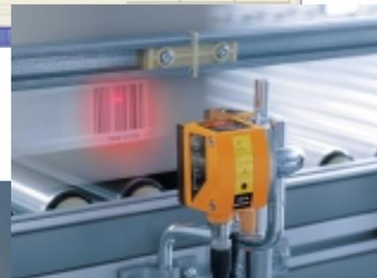
L'appareil compact est fixé avec le kit de montage correspondant et raccordé au système de commande (API) via l'interface process. Le paramétrage est effectué via un câble Ethernet avec un PC usuel.
