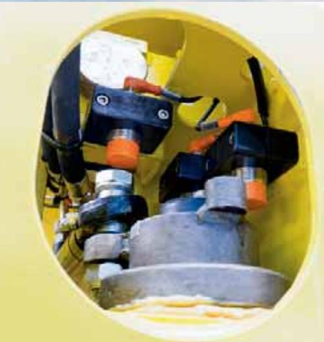
*Levage de manière sûre : les détecteurs inductifs ifm surveillent le verrouillage du conteneur avec le spreader.*
