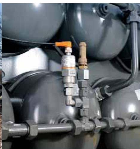
*Dans la rue et sur les rails : un capteur de pression pour engins mobiles contrôle le système de freinage à air comprimé d'un véhicule rail-route.*
