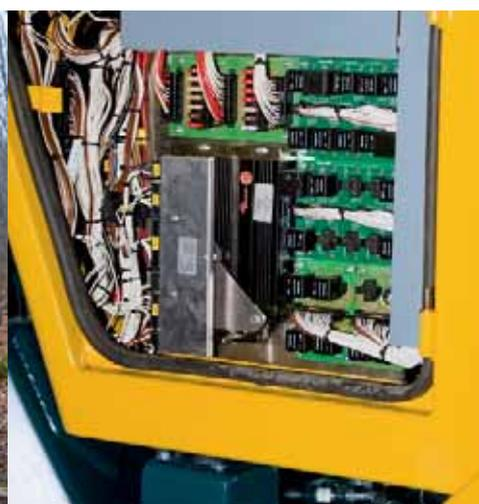
*Véhicule d'exploitation forestière avec chargeur : la commande du véhicule et de l'application s'effectue via le système de contrôle-commande ecomatmobile.*
