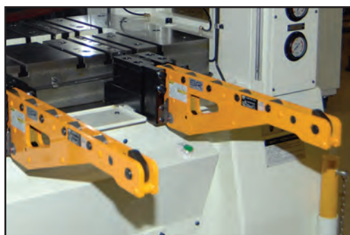
Die Lift Rails
