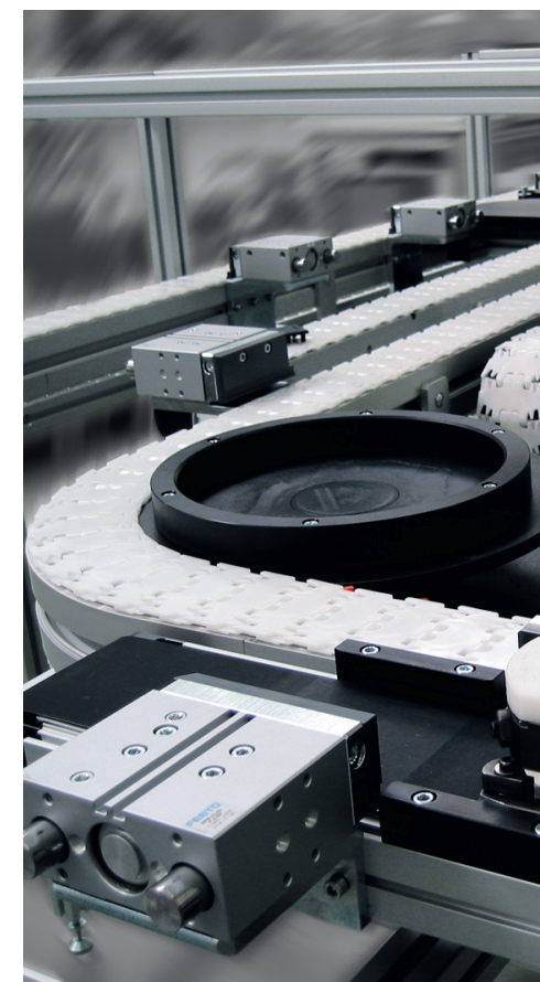
Gliederkettenförderer GKF 90 Chain conveyor GKF 90 Courbe à chaîne à palettes Transportador de cadena GKF 90
