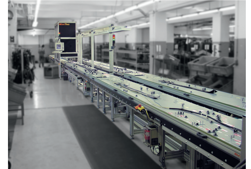
Montagelinie für Kabelbäume Assembly line for cable trees Ligne de montage pour faisceaux de câbles Línea de montaje para cables
