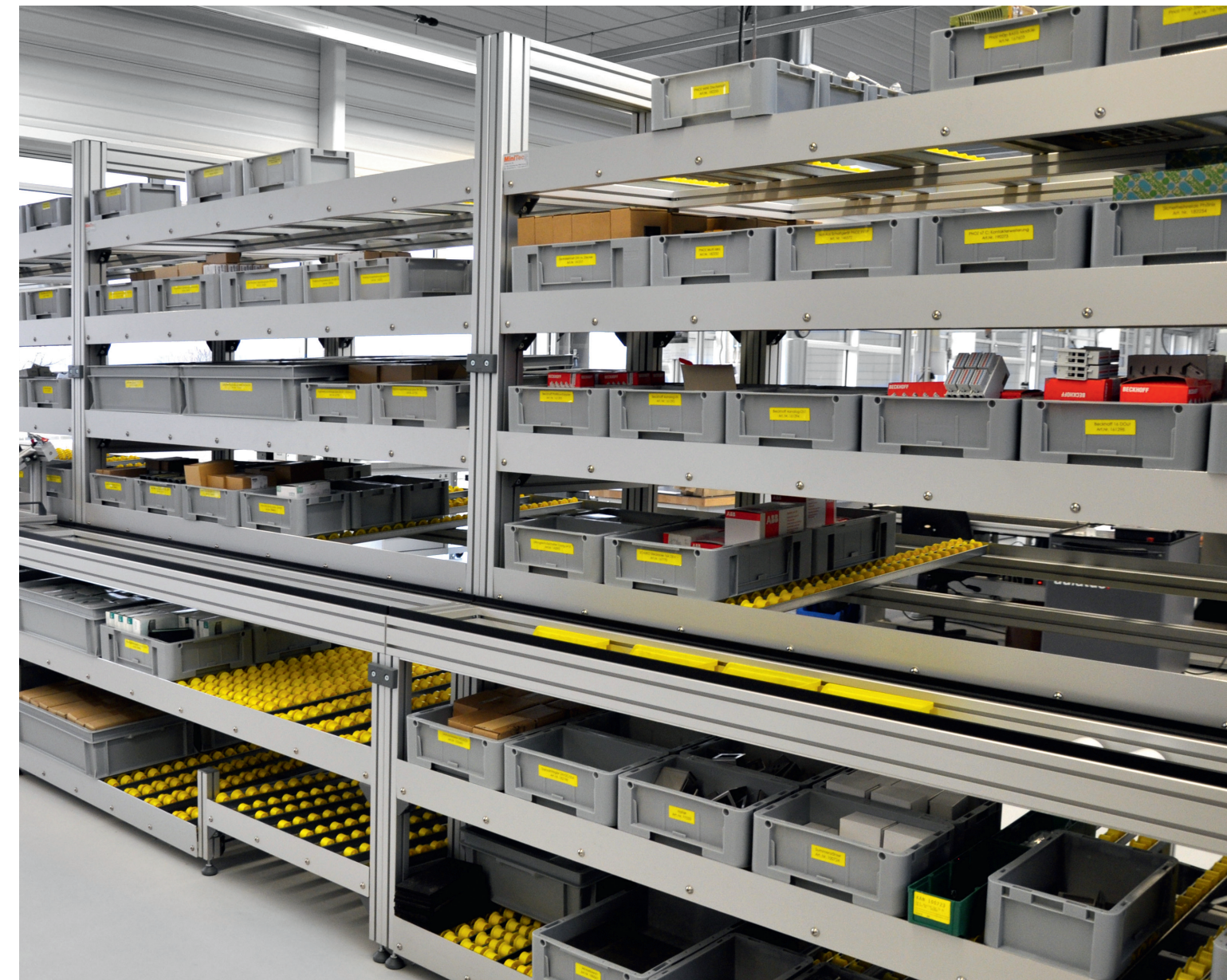
Kanban System mit mobilen Montageinstallationen Kanban system with mobile mounting installations Ligne d'assemblage avec convoyeur gravitaire et plateaux de montage Línea de ensamblado con transportador de gravedad y palets de montaje
