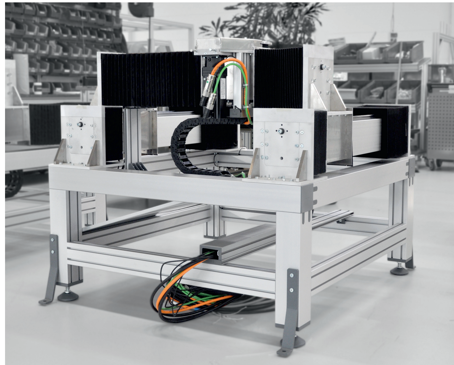
Montageanlage für Ceranfelder mit hochdynamischen Linearantrieben
