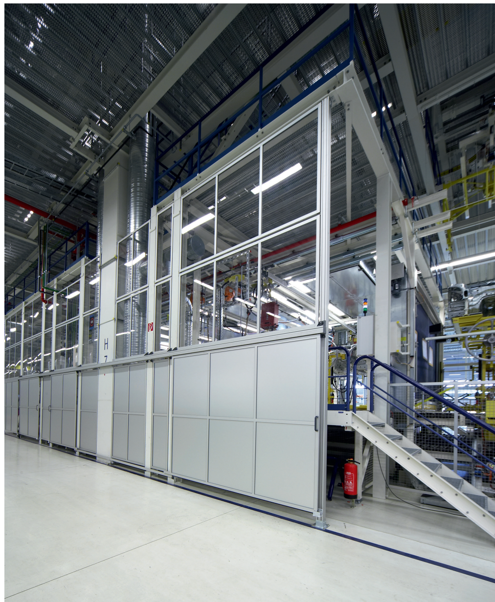
Schutzeinrichtung Endmontage | Safety guard final assembly | Dispositif de protection sur ligne Dispositivo de protección en línea
