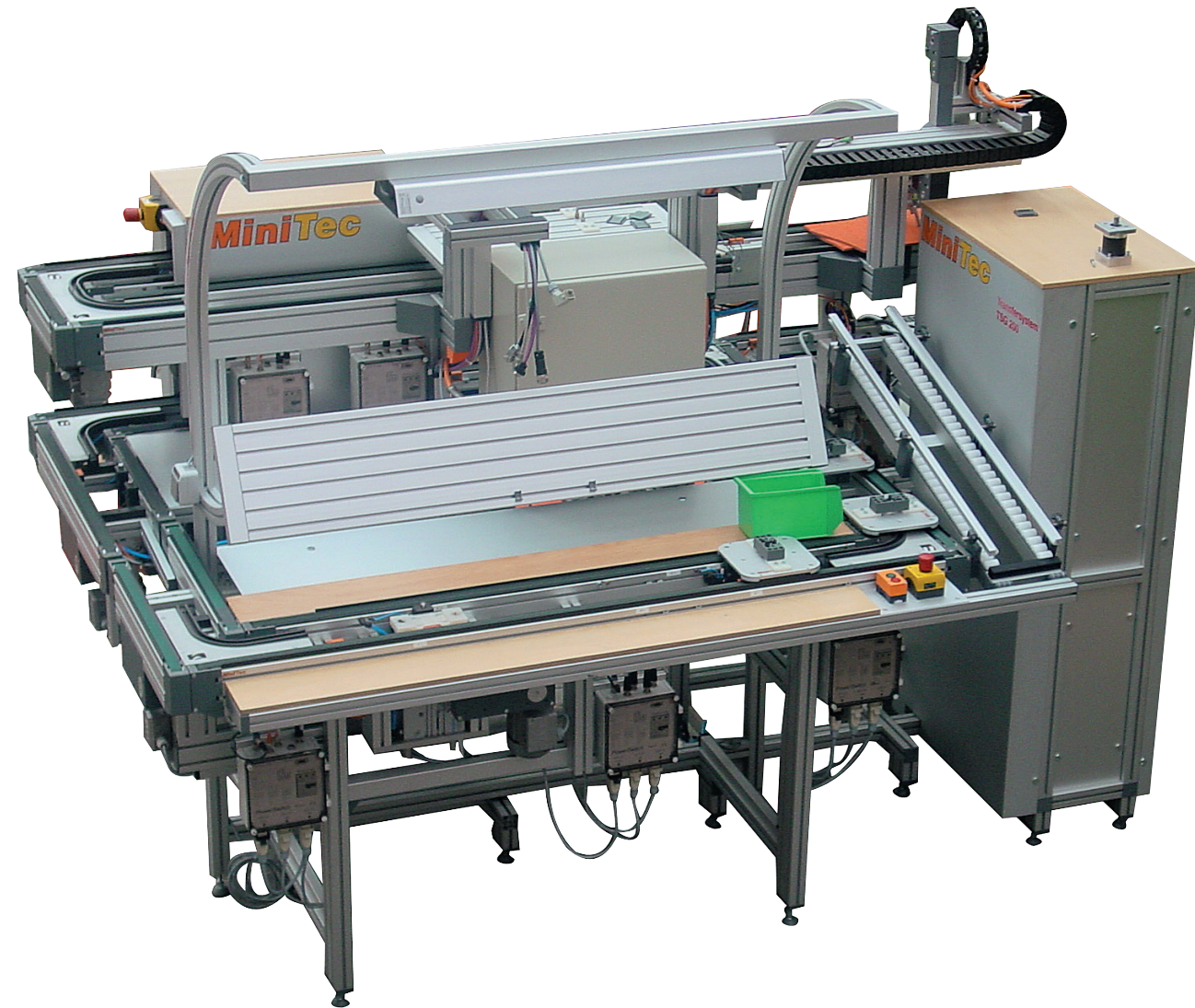
Flexibles Palettentransfersystem mit Positionierer, Liftstation und Hubeinrichtung
