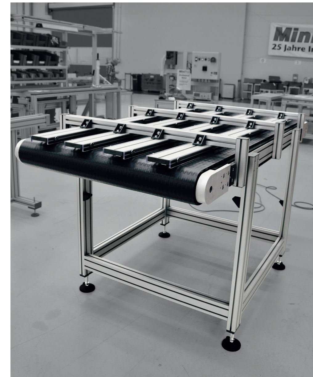
Förderband mit Spurverstellung | Conveyor belt tracking adjustment | Convoyeur à bande avec guides réglables Transportador de banda con guías regulables
