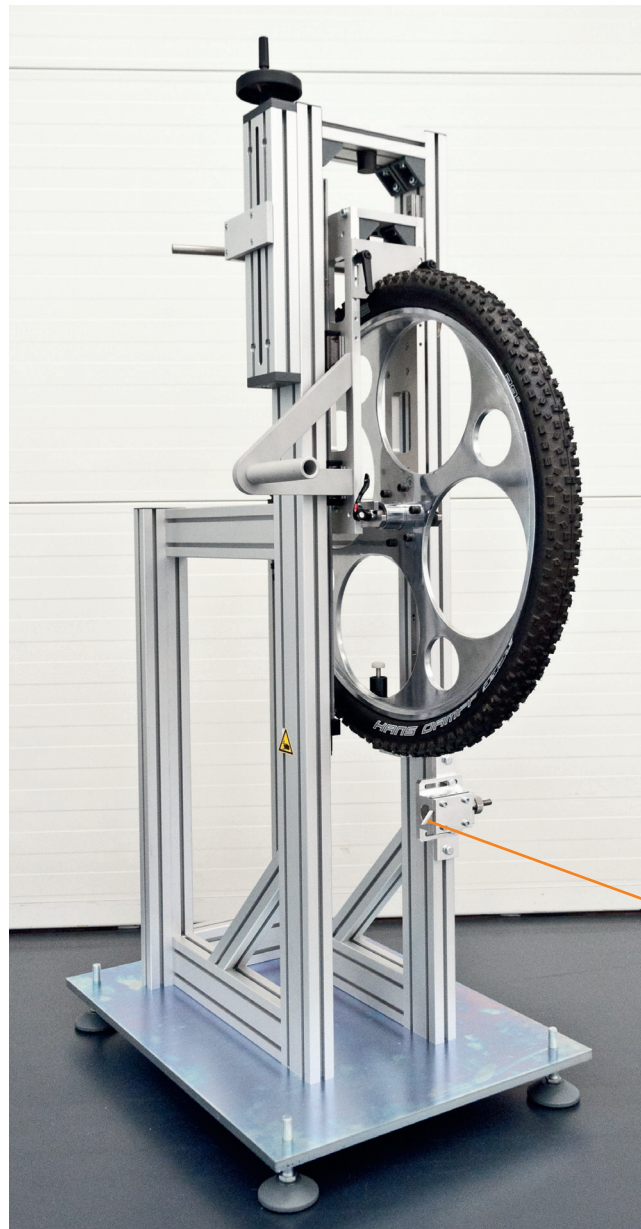
Testvorrichtung für Fahrradreifen Testing device for bicycle tyres Dispositif pour contrôle de pneumatique pour cycle Dispositivo de control para ruedas de bicicleta
