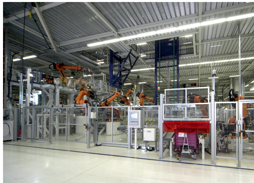
Schutzanlagen mit Schleuse | Safety fences with material lock | Dispositif de protection avec sas | Dispositivo de protección con puertas de cierre
