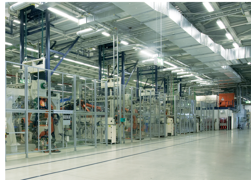
Schutzanlagen mit Schleuse | Safety fences with material lock | Dispositif de protection avec sas | Dispositivo de protección con puertas de cierre
