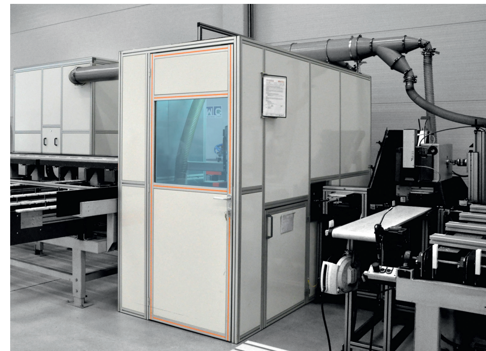
Lärmschutzkabine für Säge | Noise protection cabin for saw | Cabine de protection anti-bruit pour scie | Cabina de protección anti-ruido para sierra
