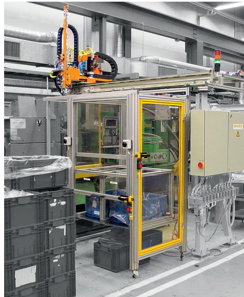
Schutzeinrichtung für Beladestation Protective device for loading Dispositif de protection pour le chargement Dispositivo de protección para cargas
