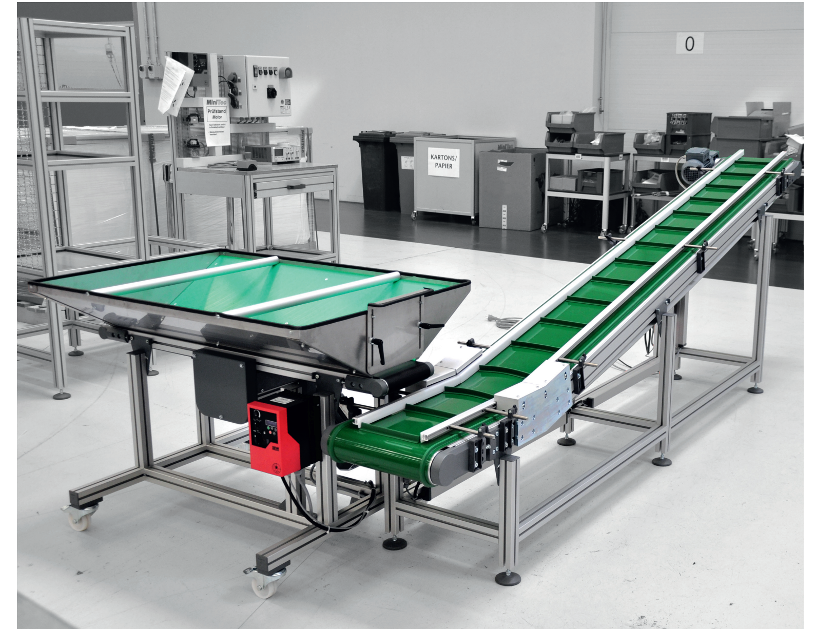
Teilevereinzelung mit Förderband Part separation with conveyor belt Convoyeur d'alimentation Transportador de alimentación
