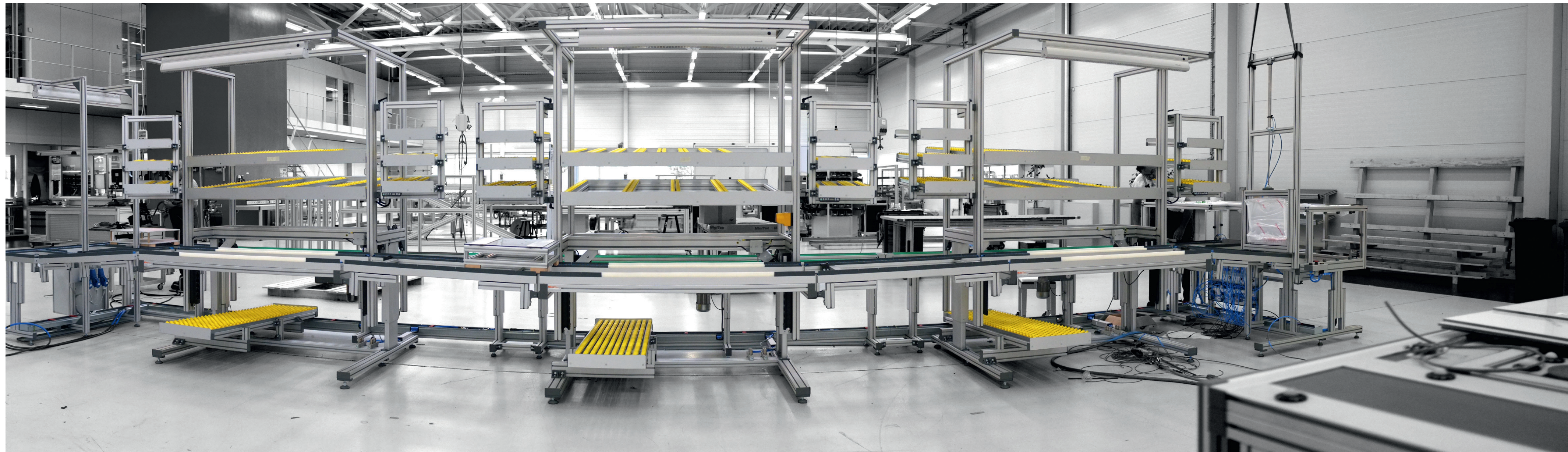
Montagelinie mit Materialbereitstellung und Werkstückträgersystem | Assembly line with material provision and tooling system | Ligne d'assemblage | Línea de ensamblado
