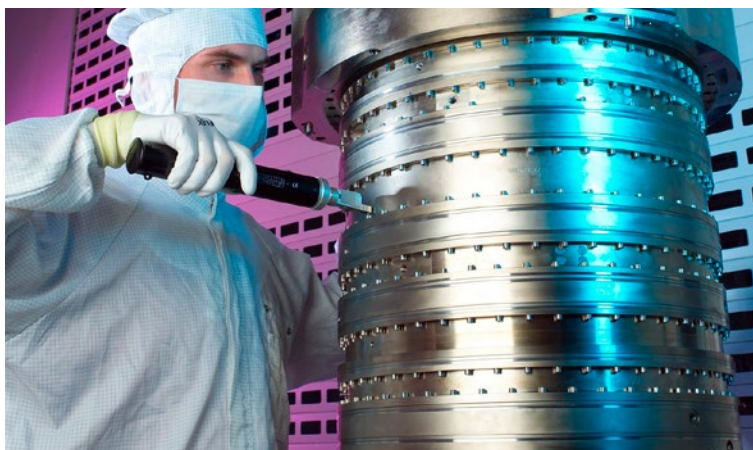
Ajustage au nanomètre près de lentilles dans des objectifs destinés à la réalisation de masques de wafers à l'aide de capteurs de déplacement capacitifs.
