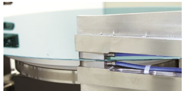
Mesure d'épaisseur du wafer avec deux capteurs capacitifs
