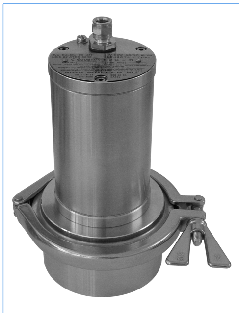
Projecteur type EdelEx STERI-LINE 20 dH, 24 V, 20 W, Ex d IIC T4 Gb, Ex t IIIC T130°C Db IP67, Ex II 2 G + D, sur hublot à verre moulé, DN 100
