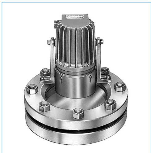
Type non adf KL PowerLED Sch B, 24 V AC / DC, 7 W, avec pare-reflets «B», monté sur hublot selon DIN 28120, DN 150, PN 10, en version «vue et éclairage par un seul hublot».
