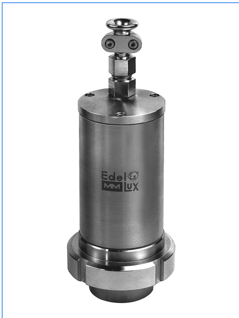
Projecteur type EdelEx 10 dH R50 K1, 10 W, 230 V, Ex d IIC T4 Gb, Ex t IIIC T130°C Db IP67, Ex II 2 G + D, avec fixation par disque à col étiré «R» sur hublot à visser similaire à DIN 11851, PN 6, DN 50.
