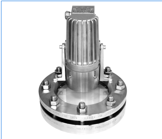
Type HEL 35 deHSchB, Ex d e IIC T4 Gb, Ex t IIIC T130°C Db / IP67, Ex II 2 G + D, 230 V, 35 W, version halogène, avec pare-reflets «B», monté sur hublot selon DIN 28120, DN 150, PN 6, en version «vue et éclairage par un seul hublot».
