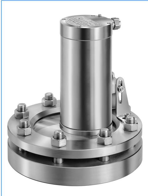
Projecteur type EdelEx 50 dH Sch K2, 50 W, 230 V, Ex d IIC T4 Gb, Ex t IIIC T130°C Db IP67, Ex II 2 G + D, avec fixation par charnière «Sch» sur hublot rond selon DIN 28120, PN 10, DN 150.
