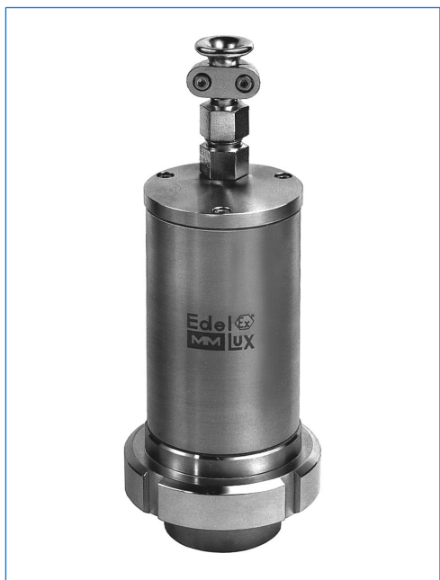
Projecteur type EdelEx d LED R50 K1, 2 W, 24 V AC/DC, Ex d IIC T6 Gb, Ex t IIIC T80°C Db, IP65/67, Ex II 2 G + D, avec fixation par disque à col étiré «R» sur hublot à visser similaire à DIN 11851, PN 6, DN 50.
