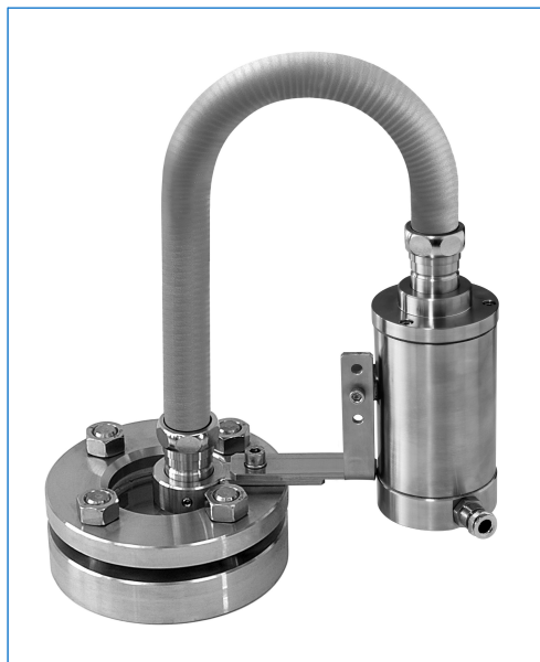
Projecteur adf à fibre optique entièrement en acier INOX, type fibroLUX E d PowerLED W W2 K2, Ex II 2 G + D, 7 W, 24 V AC / DC, fixation de la source lumineuse avec équerre «W», fixation de la fibre optique par collier «W2» sur hublot selon DIN 28120, DN 40, PN 10
