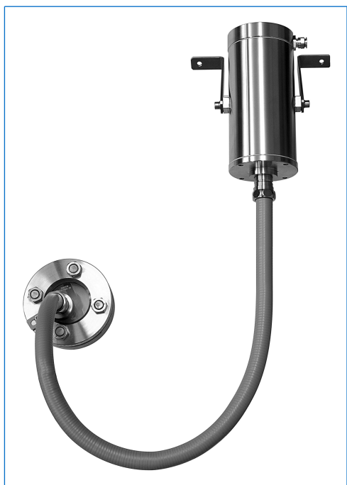
Projecteur adf à fibre optique entièrement en acier INOX, type fibroLUX E 5035 X1 W2, Ex d IIC T4 Gb, Ex t IIIC T130°C Db IP67, Ex II 2 G + D, 35 W, 230 V, fixation de la source lumineuse par pieds «X1», fixation de la fibre optique avec collier «W2» sur hublot selon DIN 28120, DN 40, PN 10
