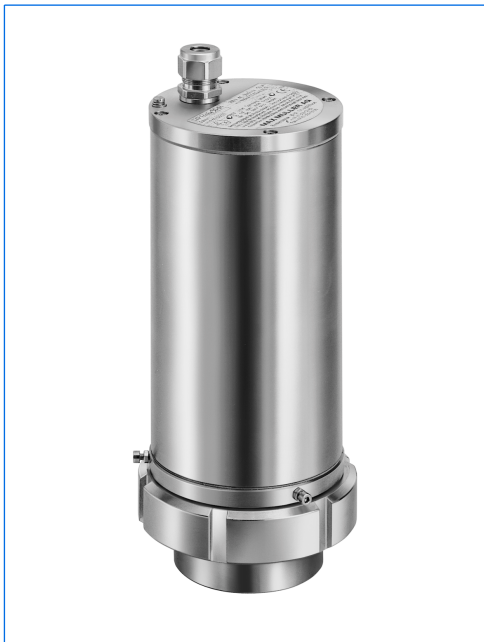
Projecteur type EdelEx G20 dH R80 K1, 20 W, 230 V, Ex d IIC T5 Gb, Ex t IIIC T95°C Db IP67, Ex II 2 G + D, avec fixation par disque à col étiré «R 80» sur hublot vissé similaire à DIN 11851, PN 6, DN 80.
