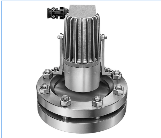
Type PEL 50 deH X2 B, 230 V, 50 W, Ex d e IIC T4 Gb, Ex t IIC T130°C Db IP67, Ex II 2 G + D, avec pare-reflets «B», sur hublot selon DIN 28120, DN 150, PN 10, en version «vue et éclairage par un seul hublot».
