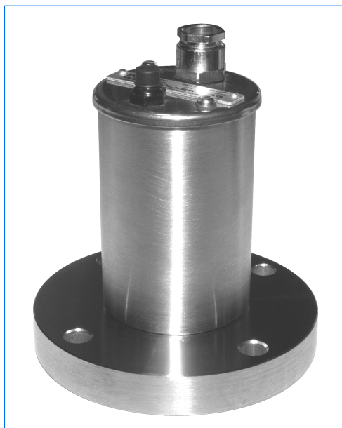
Projecteur type BKVLR 20 HDA, 20 W, 24 V, avec bouton-poussoir «D», monté sur hublot à verre moulé pour des raccordements aseptiques selon DIN 11864-2, DN 50
