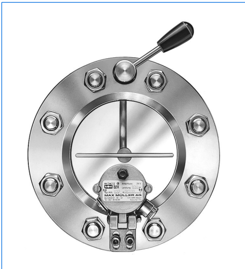
Essuie-glace, système WS, monté dans un hublot VETROLUX® selon DIN 28120, PN 10, DN 100, avec projecteur miniLUX®, type KVL 50 HDSch, 24 V, 50 W, en version «vue et lumière par un seul hublot».
