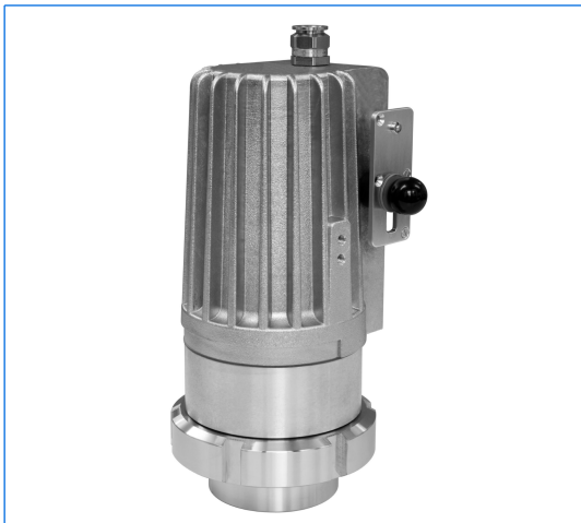
Type FHEL 35 dhVRK1, Ex d IIC T4 Gb, Ex t IIIC T130°C Db / IP67, Ex II 2 G + D, 230 V, 35 W, version halogène, avec temporisation «V», montage par disque à col étiré «R» sur hublot vissé similaire à DIN 11851, DN 65, PN 6.
