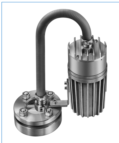
Projecteur adf à fibre optique avec temporisation intégrée «U», type fibroLUX® 5035 W W2 U sp, Ex d e IIC T4 Gb, Ex t IIIC T130°C Db IP67, Ex II 2 G + D, 35 W, 24 V AC, fixation de la source lumineuse avec équerre «W», fixation de la fibre optique par collier «W2» sur hublot selon DIN 28120, DN 40, PN 10
