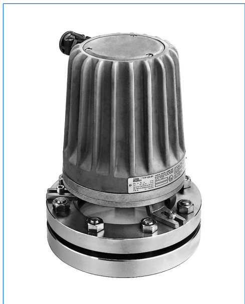
Projecteur de haute performance type 100 deHN, 100 W, 24 V, Ex d e IIC T4 Gb, Ex t IIIC T130°C Db IP67, Ex II 2 G + D, fixation par trépied «N», monté sur hublot selon DIN 28120, PN 10, DN 125
