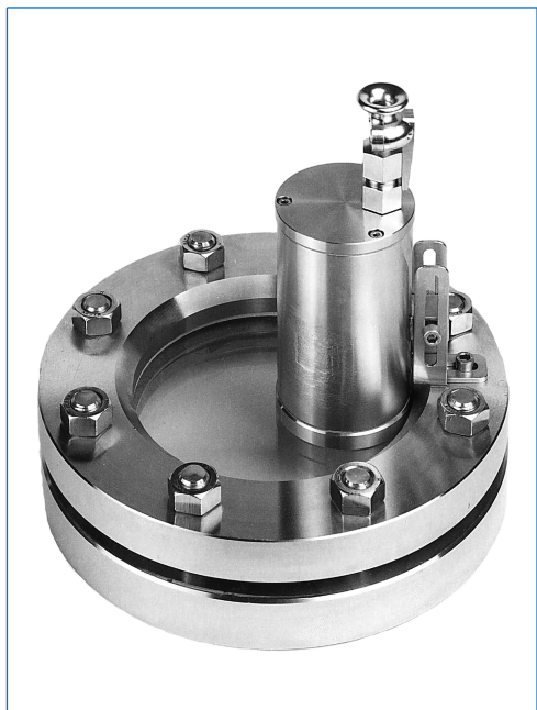
Projecteur type EdelEx 20 dH Sch K1, 20 W, 24 V, Ex d IIC T4 Gb, Ex t IIIC T130°C Db IP67, Ex II 2 G + D, avec fixation de charnière «Sch» sur hublot rond selon DIN 28120, PN 10, DN 125.
