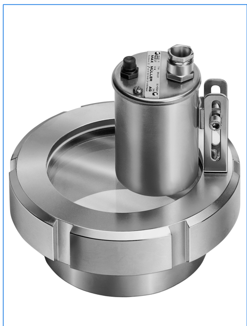
Projecteur type BKVLR LED DSch1, 24 V, avec bouton-poussoir «D», monté sur hublot vissé similaire à DIN 11851, DN 100, PN 6, en version «vue et éclairage par un seul hublot».
