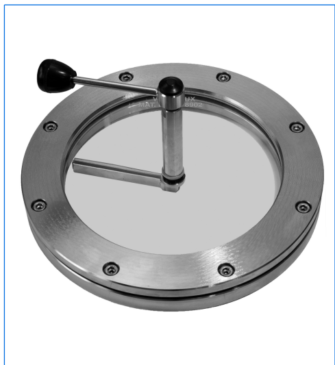
Hublot rond, DN 150, PN 0, avec verre précontraint en silicate de soude selon DIN 8902 et essuie-glace de la gamme W avec balai en silicone
