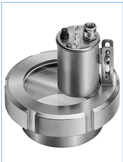
Projecteur type BKVLR 50 HDSch1, 50 W, 24 V, avec bouton-poussoir «D», monté sur hublot vissé similaire à DIN 11851, DN 100, PN 6, en version «vue et éclairage par un seul hublot».
