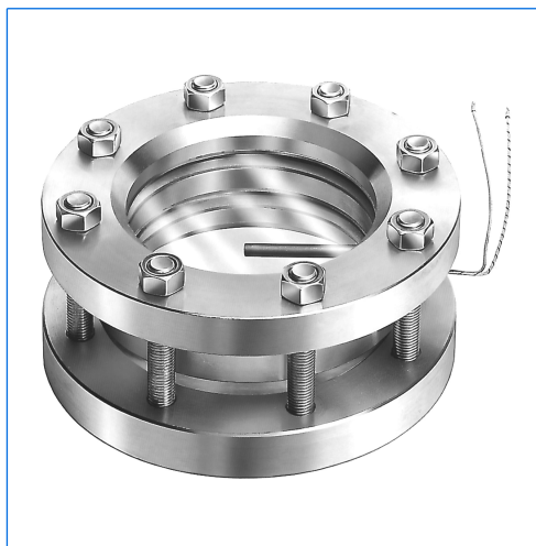
Hublot à double vitrage similaire à DIN 28120, DN 150, PN 16, avec élément chauffant intégré, 24 V, 50 W
