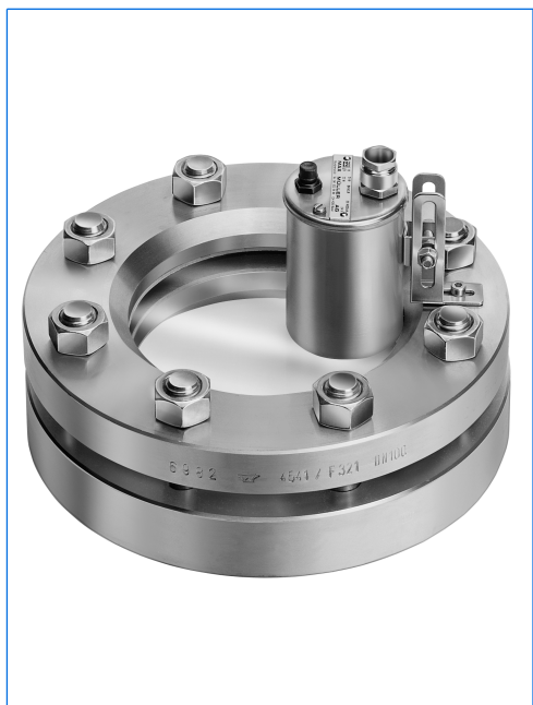
Projecteur type BKVLR 20 HDSch, 20 W, 24 V, avec bouton-poussoir «D», monté sur hublot selon DIN 28120, DN 100, PN 10, en version «vue et éclairage par un seul hublot».
