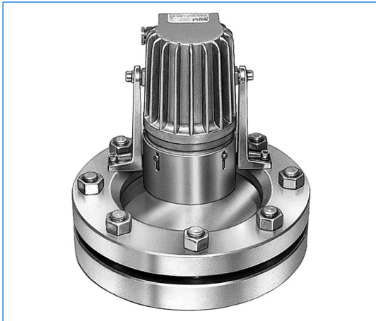
Type KL 100 H Sch B, 24 V, 100 W, avec pare-reflets «B», monté sur hublot selon DIN 28120, DN 150, PN 10, en version «vue et éclairage par un seul hublot».
