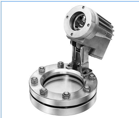
Type PEL 20 deH Sch, 230 V, 20 W, Ex d e IIC T6 Gb, Ex t IIC T80°C Db IP67, Ex II 2 G + D, monté sur hublot selon DIN 28120, DN 125, PN 10, en version «éclairage».
