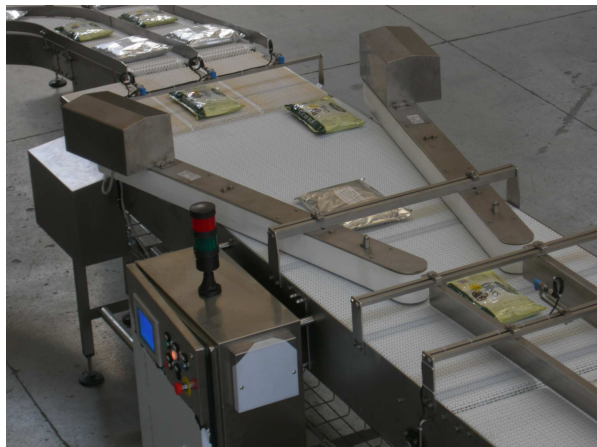
Unificatore DU31L-V02 ad elevata velocità per buste di olive dotato di vomeri motorizzati
