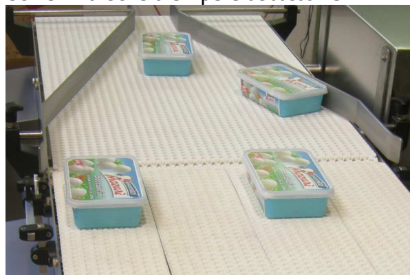
Unificatore DU41M in fase di evacuazione prodotto
