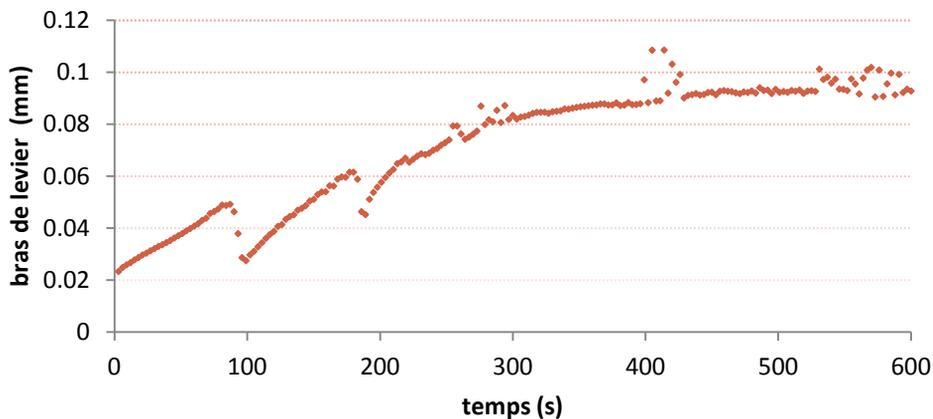
**Figure de la gauche:** Evolution du coefficient de frottement (exprimé par un bras de levier) d'un roulement à bille acier/acier **sans** lubrification sous une contrainte définie au cours des dix premières minutes. Des revêtements montrant une lubrification à sec performante ont été identifiés lors de ce projet.
