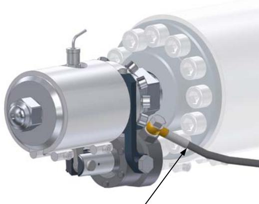
Pour l'amorçage pneumatique ou hydraulique, nous avons recours à des cylindres de levage double effet spécialement construits avec des joints résistants au chaud (jusqu'à 180°C). L'amorçage constitue avec le sous-groupe de la buse une unité compacte. Le cylindre de levage est activé grâce à des données de réglage sur la commande de la machine.
