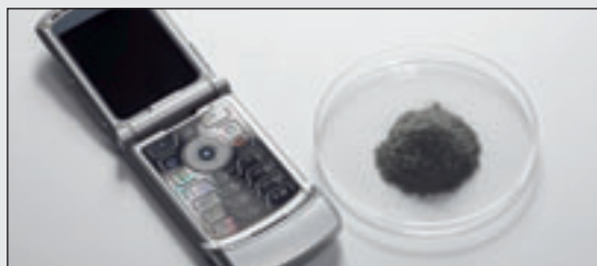
Clavier de téléphone portable : résultat du broyage après fragilisation et pulvérisation à très basse température
