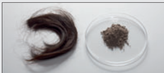
Échantillon de cheveux avant et après traitement par le broyeur PULVERISETTE 23 de FRITSCH
