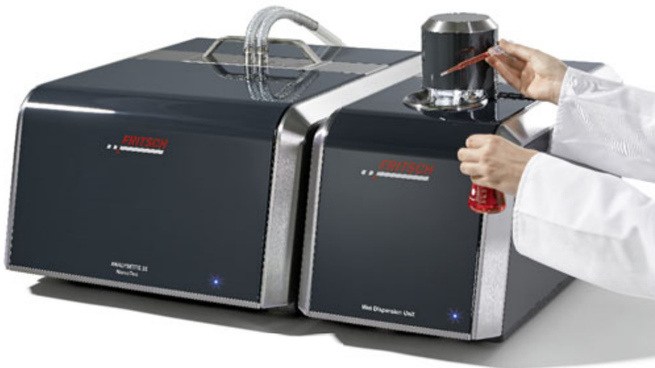
ANALYSETTE 22 NanoTec – un système modulaire pratique : unité de mesure avec module de dispersion par voie liquide séparé
