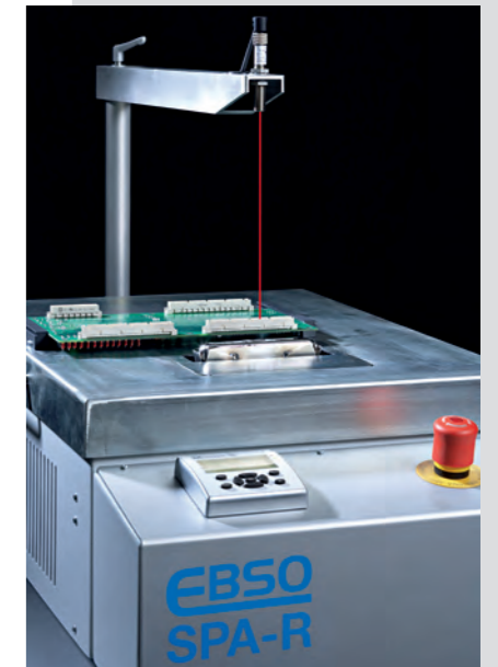
SPA-R mit Laserpointer zur Zentrierhilfe
