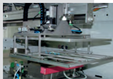
Frei programmier- barer Lötswinkel 0^\circ oder 7^\circ
