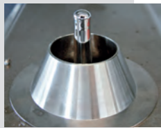
Miniwelle mit benetzbarer Lötdüse
