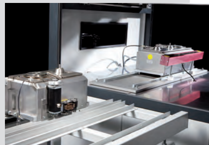
Bequemes und schnelles Wechseln der Tiegel über den Tiegelwagen
