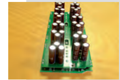
Selektivlötanwendung mit 45 mm Störkante
