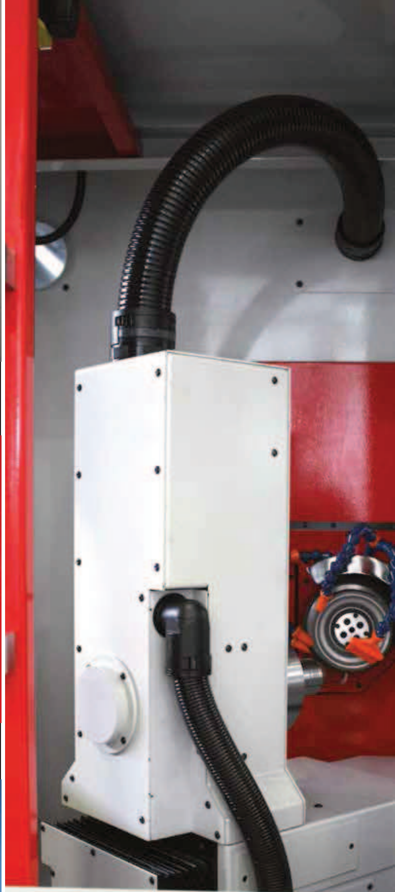
Luneta de soporte y contrapunta automática para el afilado y la fabricación de pequeñas herramientas (opcional)
