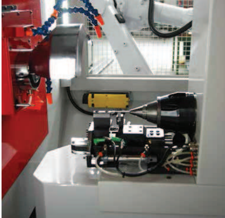
Luneta de soporte y contrapunta automática para el afilado y la fabricación de pequeñas herramientas (opcional)
