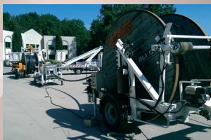
Atelier fixe de spiraleuse avec enrouleuse et dérouleuse
