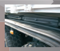
Tirris à boulonnerie
