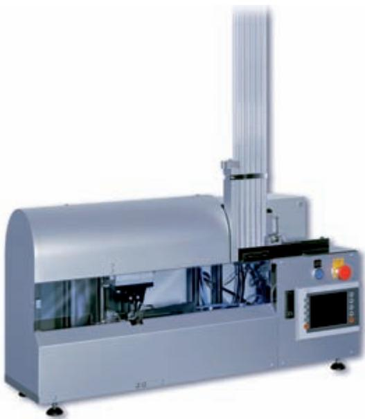
Des moyens de pose STOCKO pour chaque application. De la pince manuelle, en passant par le semi-automate, jusqu'à l'automate modulaire avec des fonctions „Juste-a-temps” comportant une interface homme machine sur PC qui permet la surveillance qualité, le diagnostic et la pré-programmation des séquences faisceaux à distance, au travers d'un modem.
