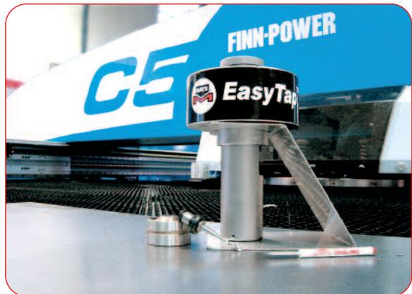
Exemple d'utilisation dans une poinçonneuse C5 de FinnPower. Cette machine possède toutes les fonctions indispensables au fonctionnement de l'outil: auto index rapide, course programmable et logiciel machine intégré et adapté.
