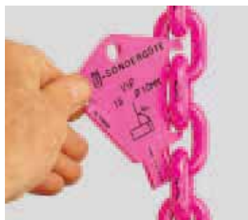
Contrôle d'allongement plastique par surcharge
