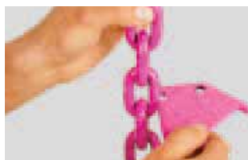
Vérification d'usure sur le diamètre extérieur du fil
