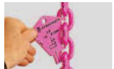
Vérification d'allongement plastique par surcharge du fil
