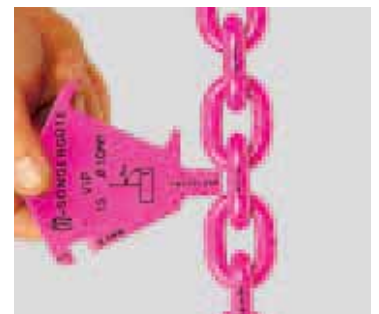
Contrôle du pas-augmentation du pas par usure du diamètre intérieur du fil
