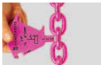
Vérification d'allongement du pas par usure du diamètre intérieur
