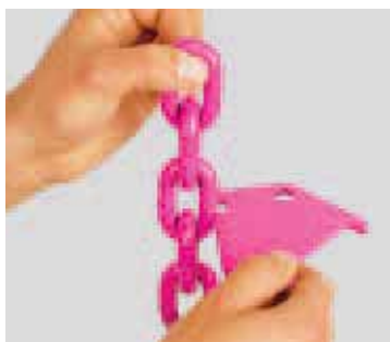
Vérification d'usure du diamètre extérieur du fil
