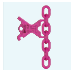
Contrôle d'allongement plastique par surcharge
