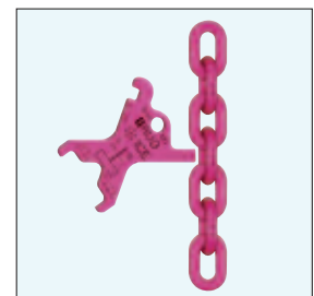
Contrôle allongement du pas par usure du diamètre intérieur du fil
