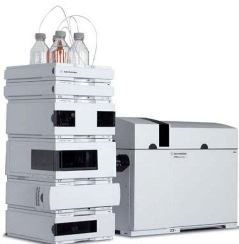
ICP-MS série 7700 avec système HPLC série 1200
