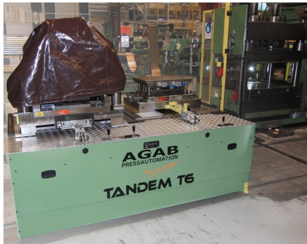
WG Tandem verktygsväxlingsvagn för max 6 000 kg
