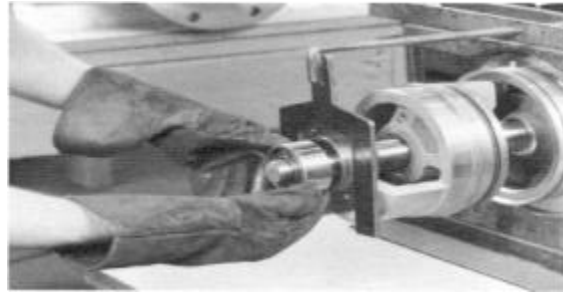
FIGURA 37 – INSTALACION DEL COJINETE DEL EJE
