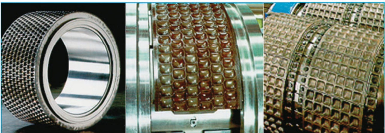
Abb. 4 Verschiedene Werkzeugausführungen (von links): Bandage, Segmente, Streifensegmente
