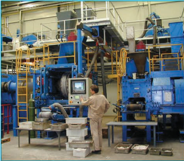
Abb. 5 Köppern Technikum. Links Walzenpresse 52/10, rechts 52/6,5
